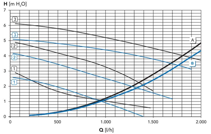
**Рис. 24. Потери нагрузки/напора циркуляционных насосов**
