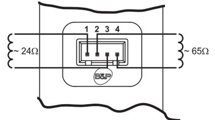
**Рис. 12. Электрический разъем для подключения газового клапана**
