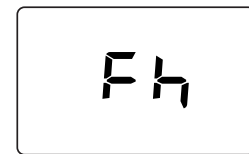
рис. 7- Выпуск воздуха с выключенным вентилятором
