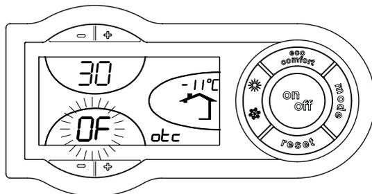
рис. 12 - Параллельное смещение кривых погодозависимого регулирования
