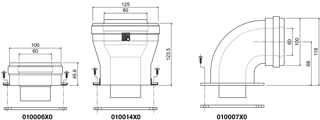
рис. 22 - Выпускные фасонные элементы для концентрических трубопроводов
