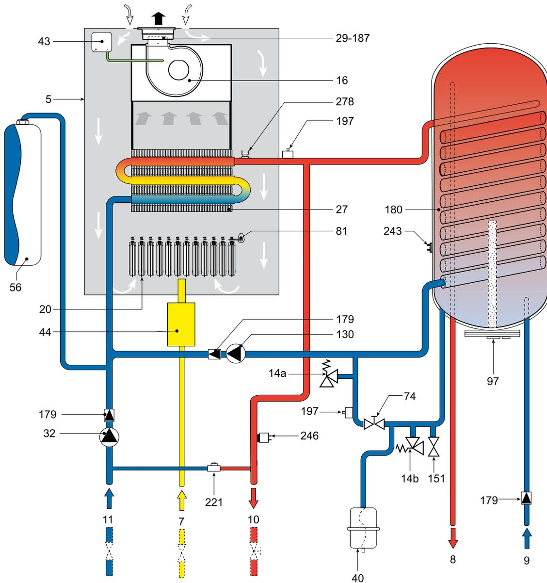
рис. 32 -Гидравлический контур
