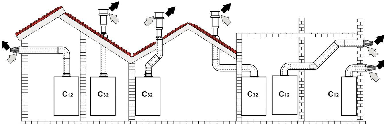
рис. 21 - Примеры соединения с помощью концентрических труб ( -воздух / - дымовые газы)
