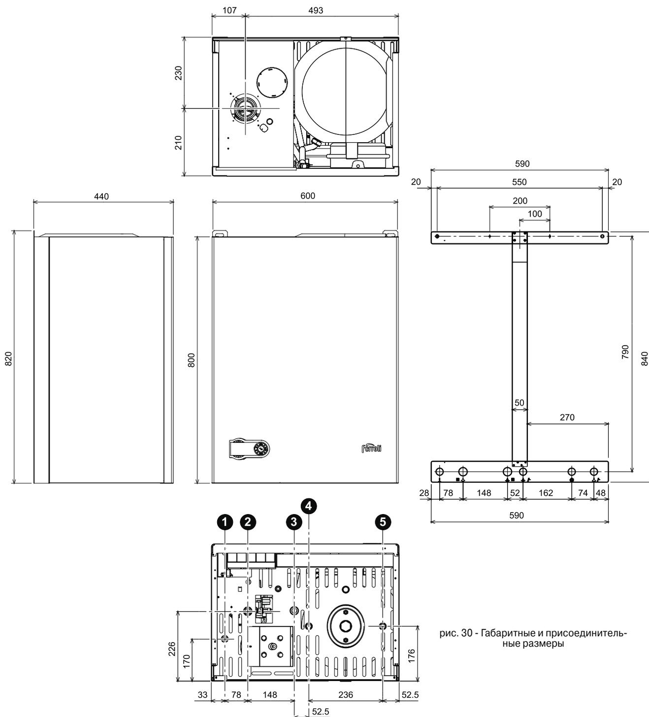
рис. 30 - Габаритные и присоединительные размеры
