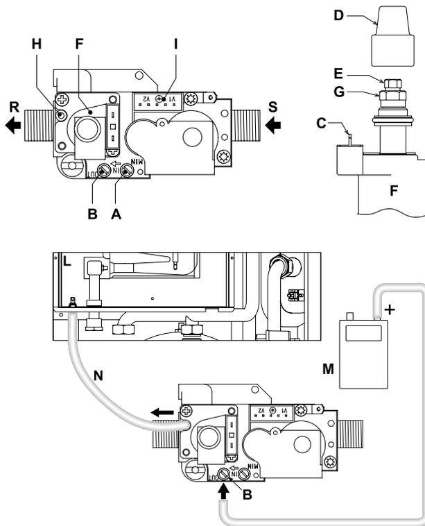
рис. 27 - Газовый клапан
