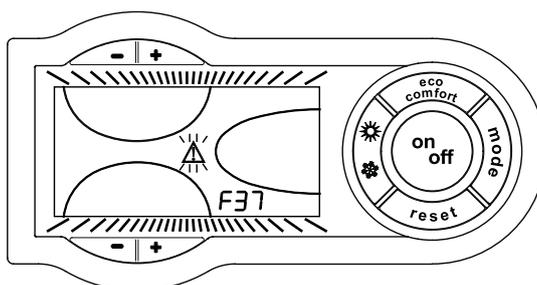
рис. 15 - Индикация недостаточного давления в системе отопления
