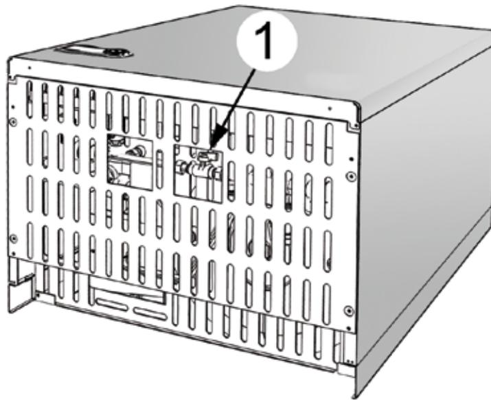
рис. 16 - Заливной кран
