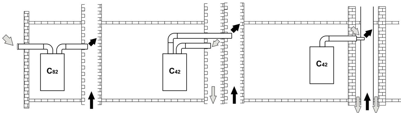
рис. 25 - Примеры подключения к дымоходам ( -воздух / - дымовые газы)
