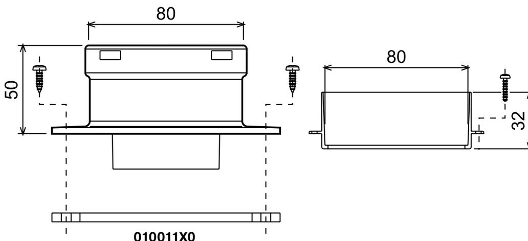
рис. 24 - Выпускные фасонные элементы для отдельных трубопроводов
