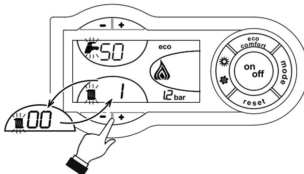
рис. 26 - Режим тестирования (мощность отопления = 100%)
