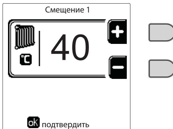
рис. 27 - Параллельное перемещение кривых
