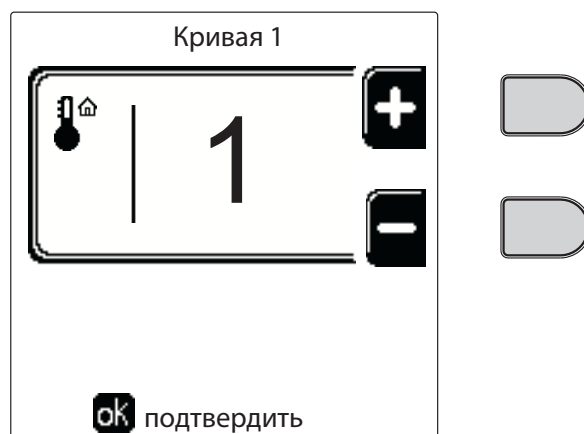
рис. 26 - Кривая погодозависимого регулирования
